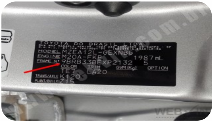
PARTE EXTRA 1 OBSERVAÇÃO ETIQUETA DE CHASSI - COLUNA B, LADO ESQUERDO.
